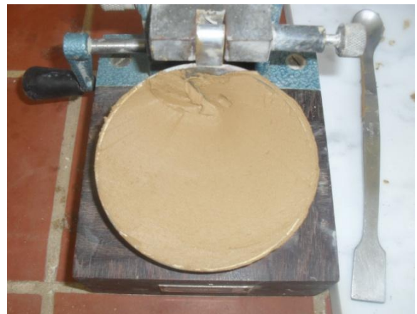
Photo 2: Remplissage de la coupelle par le mélange de sol
