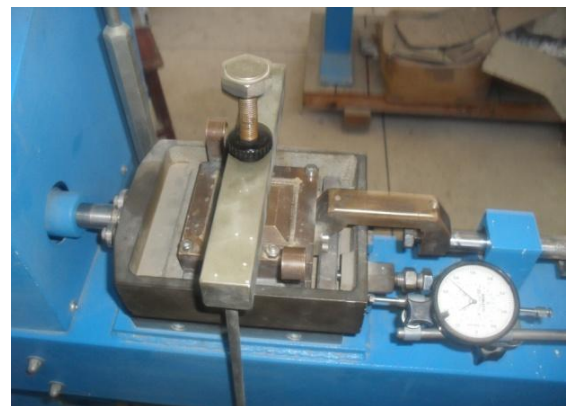
Photo 5 : Echantillon à cisailier placé à l'intérieur des deux demi-bottes
