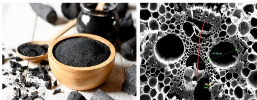
Figure II.2 : La structure de charbon actif
