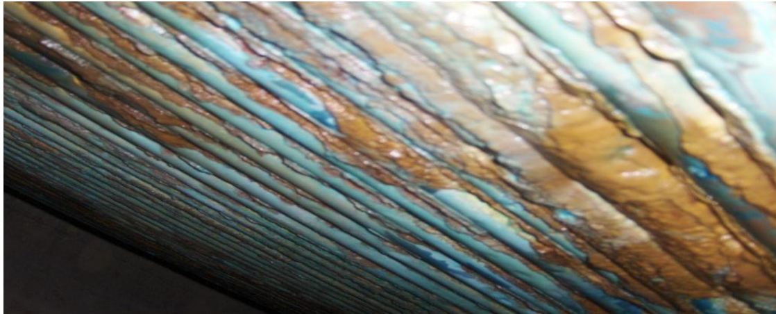
Figure III.5 : Effet de la MEA sur la surface des tubes.
