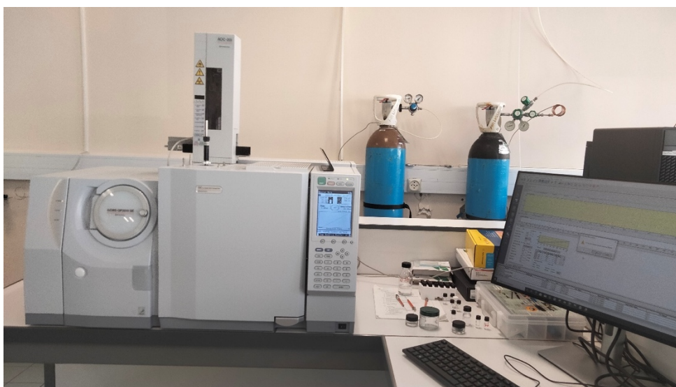
Figure 12. Chromatographe Shimadzu GC-2010 connecté à un spectromètre de masse MS-QP 2010-SE.
