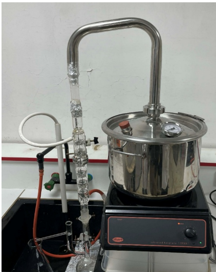
Figure 11. Dispositif d'extraction des HEs de Laurus nobilis L. par entraînement à la vapeur d'eau.
