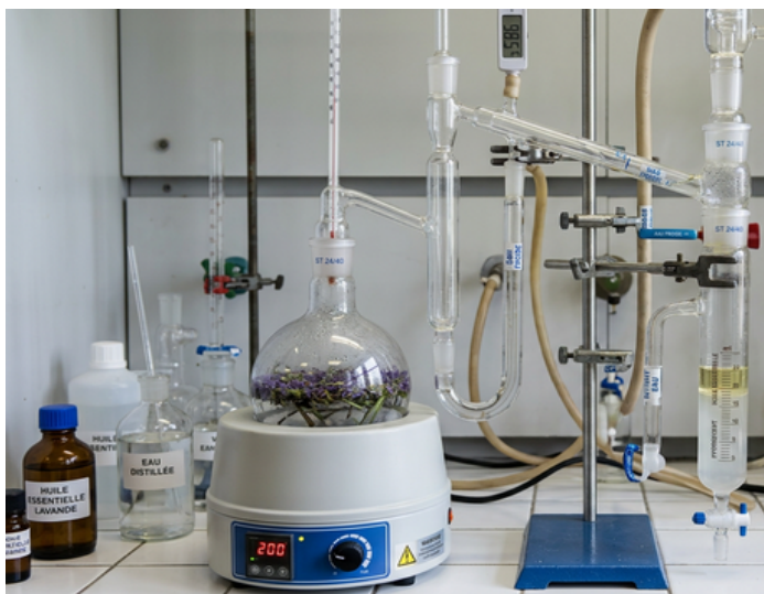
Figure 5. Montage d'hydrodistillation type Clevenger ( Hernandez Ochoa, 2005 ).
