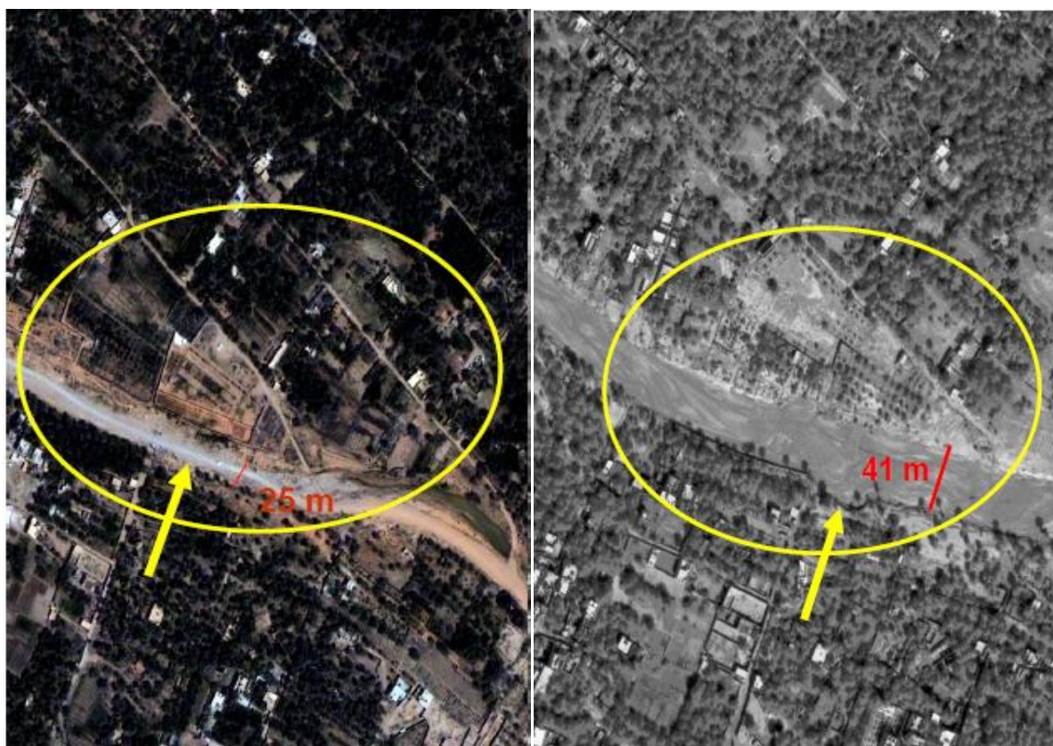
Figure 0.5: État de la vallée avant et après la crue (source : Benzahaf et Salem, 2010)
