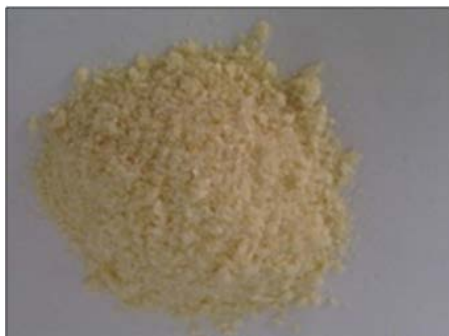
Figure 18: Aspect du chitosane après désacétylation.
