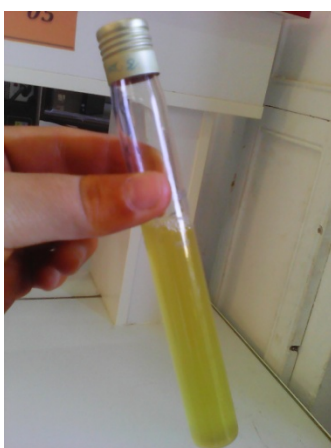
Figure 31 : Le mélange de BHIB 15 ml, Chitosane en solution 1666 µl, la souche en suspension 1666 µl.
