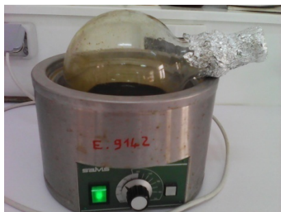
Figure12: Processus de démminéralisation avec l'HCL de 1N.
