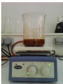
Figure 15 : Processus de déminéralisation avec l'HCL de 5N.
