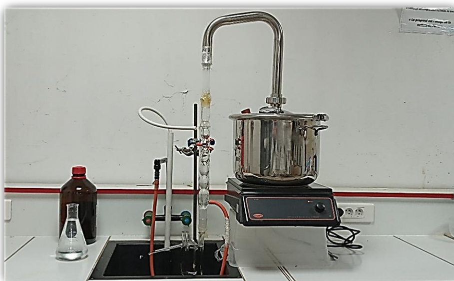
Figure 23. Dispositif d'extraction des HEs de Cinnamomum cassia L. et Illicium verum par entraînement à la vapeur d'eau.
