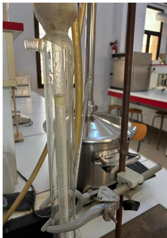
Figure 18 : Extraction de l'huile essentielle au laboratoire biochimie 2 (photo originale,2026)
