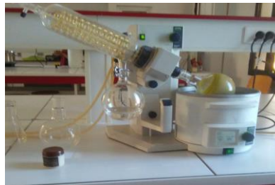
Figure11 .Evaporation dans un rota vapeur sous vide
