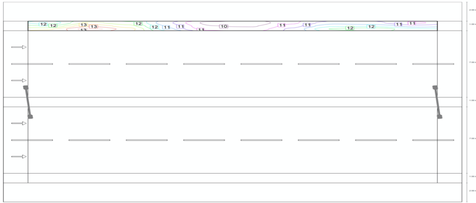
Figure IV.4 : Valeur entretien intensité d'éclairage horizontal (lignes isolux)
