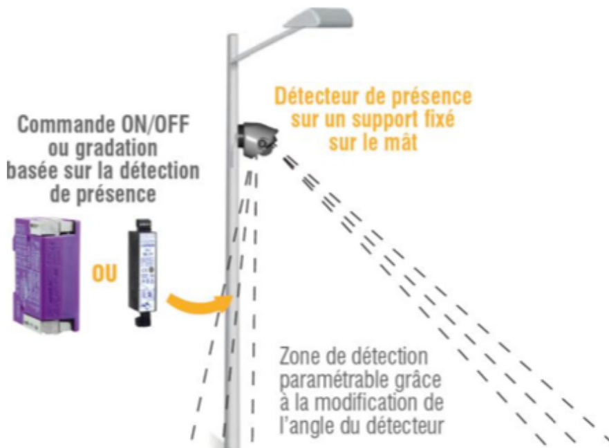
Figure III.1.5 : Fonctionnement d'un détecteur de présence
