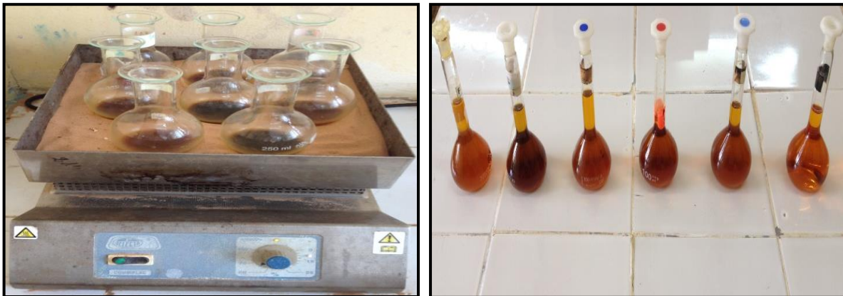
Figure N°25. Attaque au froid sur le bain de sable. Figure N°26. Séparation des phases.
