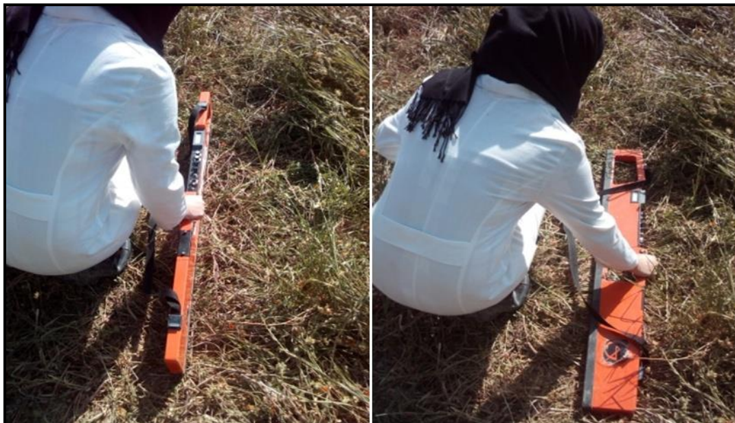
Figure n° 19 : Utilisation de l'EM38 en mode verticale et horizontale
