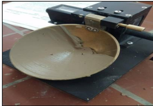
Figure (V.7) : Essai de limite Atterberg ( appareil de casagrande )
