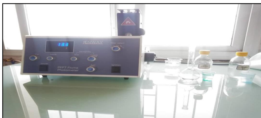
Figure (V.16) : Le spectrophotomètre à flamme pour la détermination des sels
