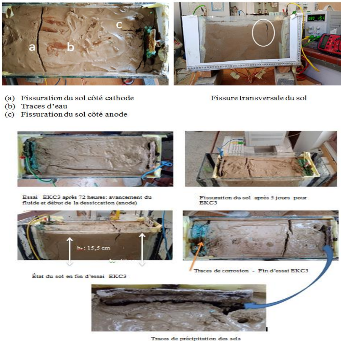
Figure (VI.22) : Etat physique du sol durant et après le traitement électrochimique.
