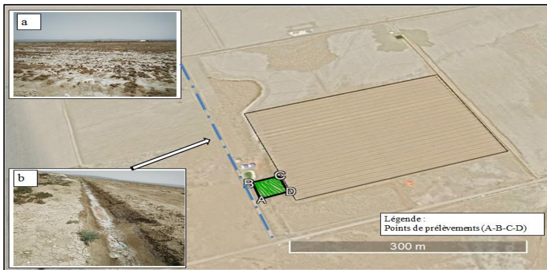
Figure V.2 : Parcelle d'étude : (a) traces de salinité, (b) système de drainage
