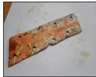
(c) anode en fin d'essai (après nettoyage)
