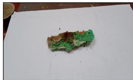
(e) anode en cuivre dégradé en fin d'essai
