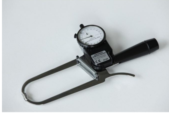
شكل (13) يوضح جهاز المساك (caliper) لقياس سمك طيات الجلد
