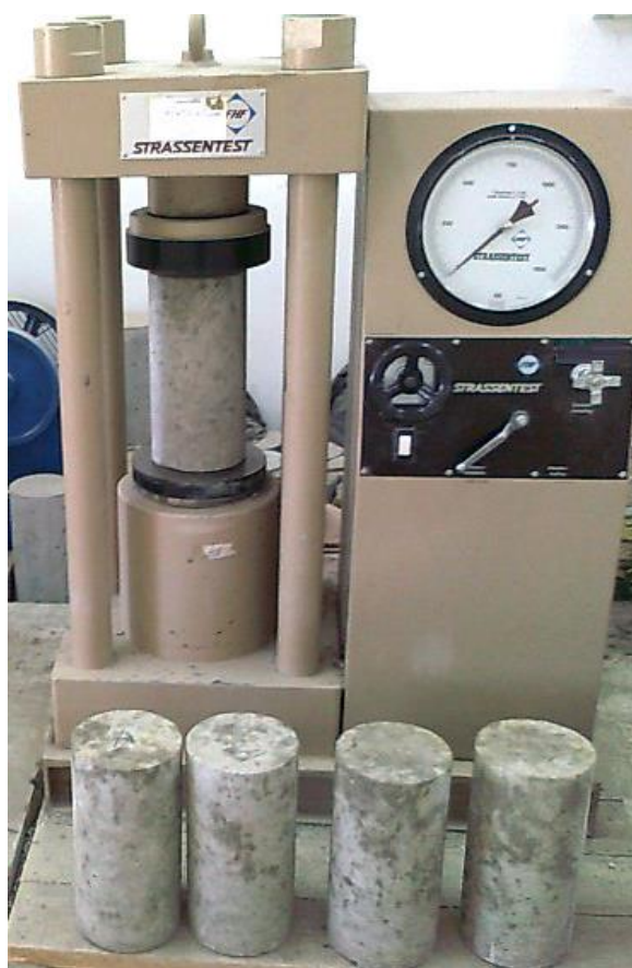
Photo 2.6 : Essais de compression sur des éprouvettes en béton
