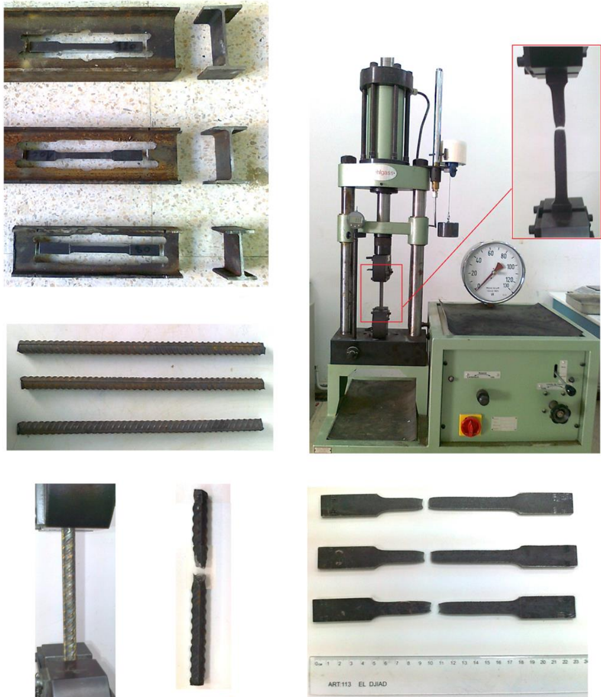
Photo 2.7 : Essais de traction sur des éprouvettes en acier
