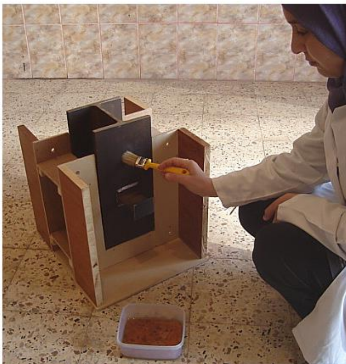
Photo C2 : Elimination de l'adhérence (acier-béton) par huilage des semelles
