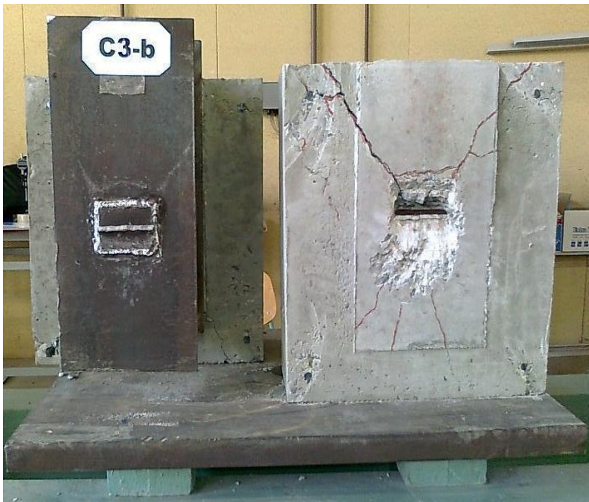
Photo 2.9 : Rupture par cisaillement de l'âme du connecteur
