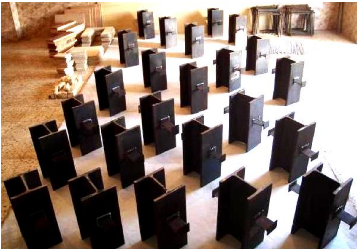
Photo 2.2 : 24 profilés métalliques en HEB160 avec des connecteurs en « I »
