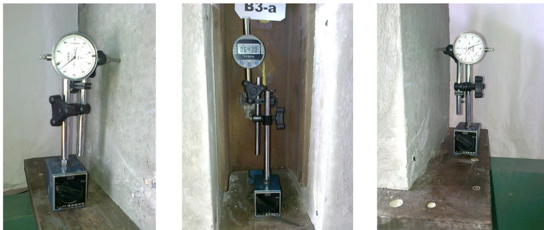
Photo C7 : Capteurs de déplacements
