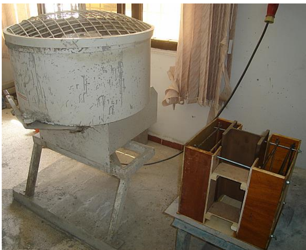
Photo C4 : Coffrage et bétonnage des spécimens de push-out
