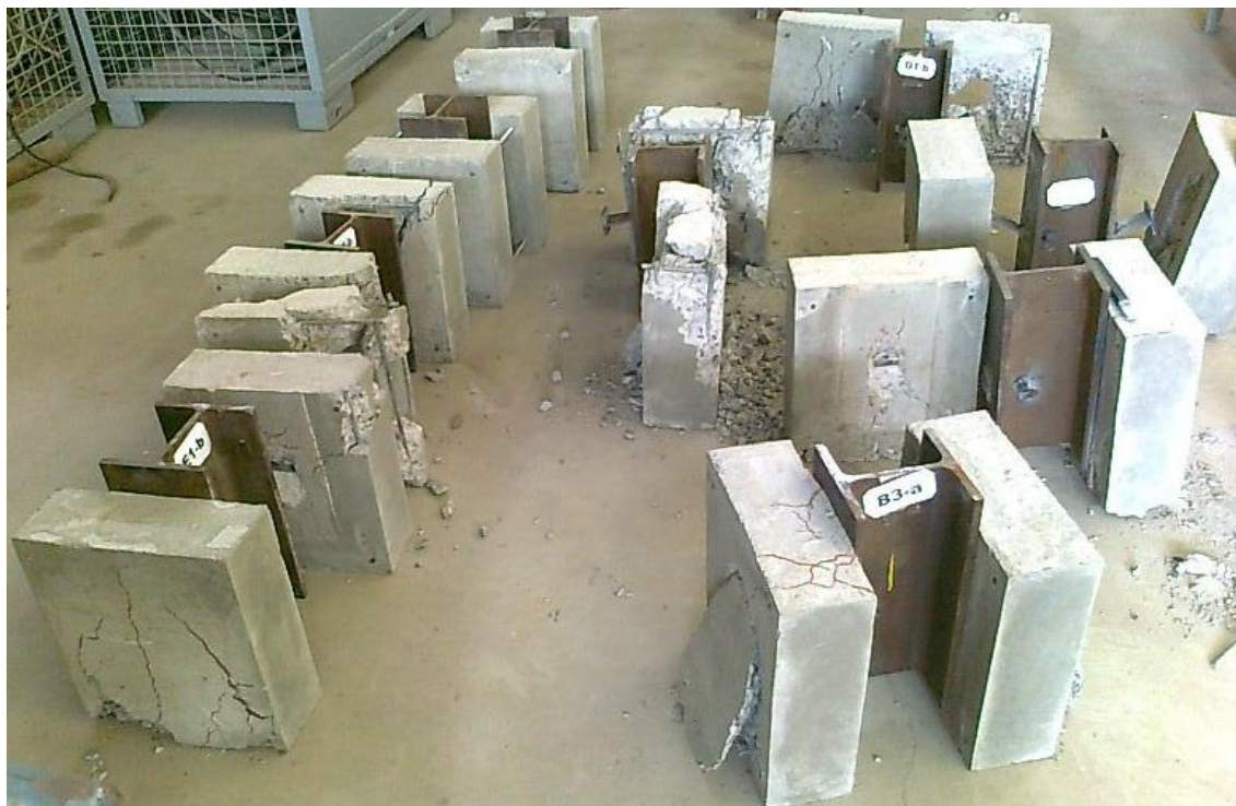
Photo C9 : Spécimens de push-out après rupture
