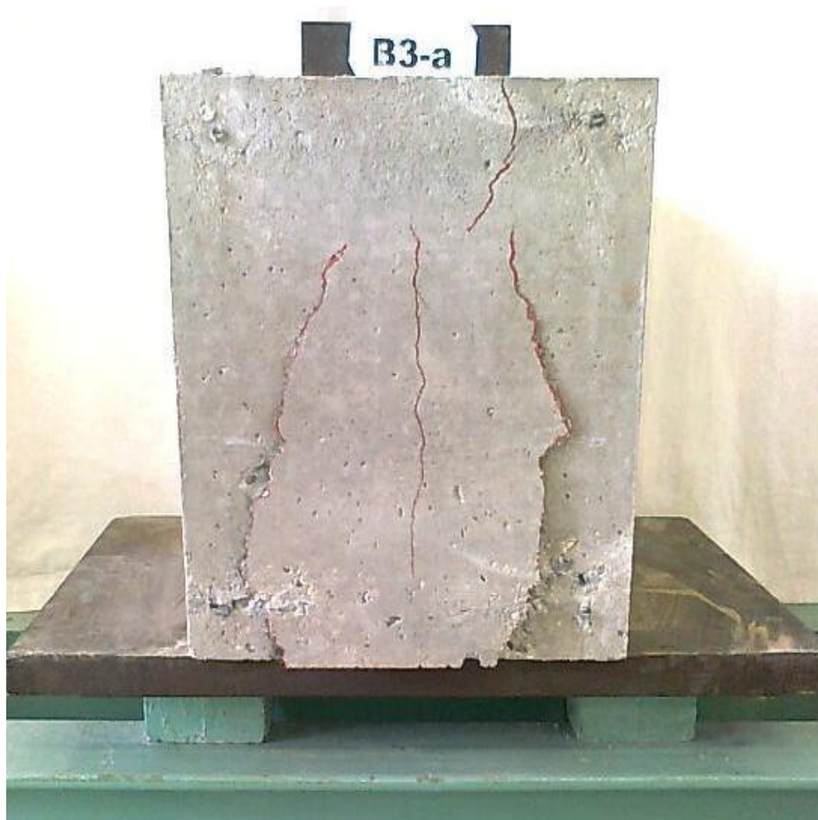
Photo 2.10 : Rupture par fissuration et écrasement du béton
