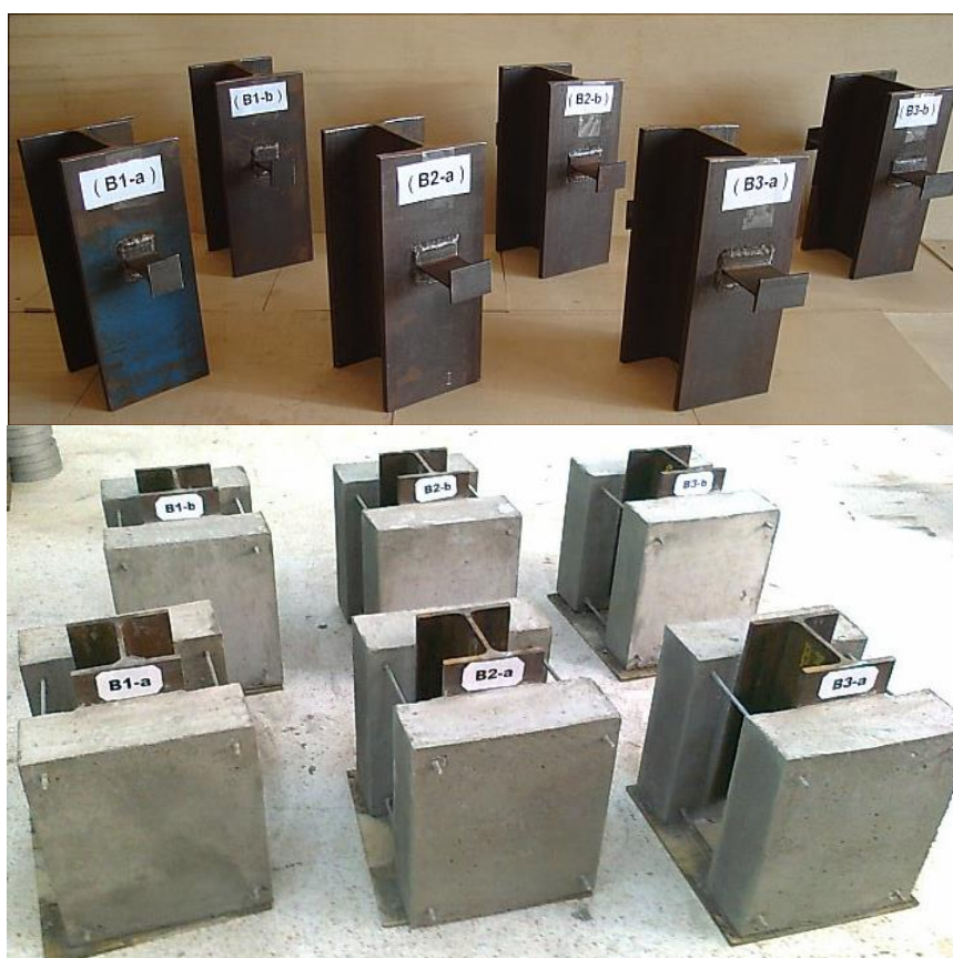
Photo C6 : Spécimens de push-out de la série B
