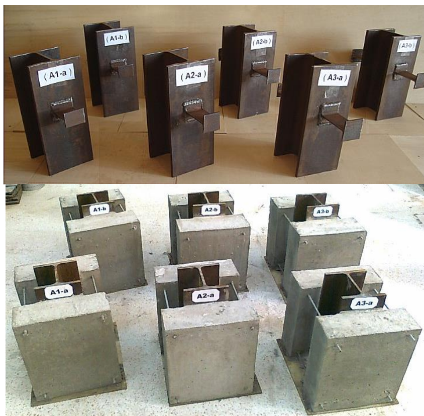
Photo C5 : Spécimens de push-out de la série A
