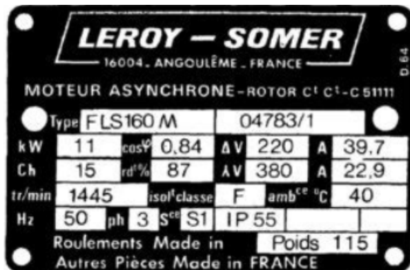
Figure III-9 : la plaque signalétique du moteur [11]
