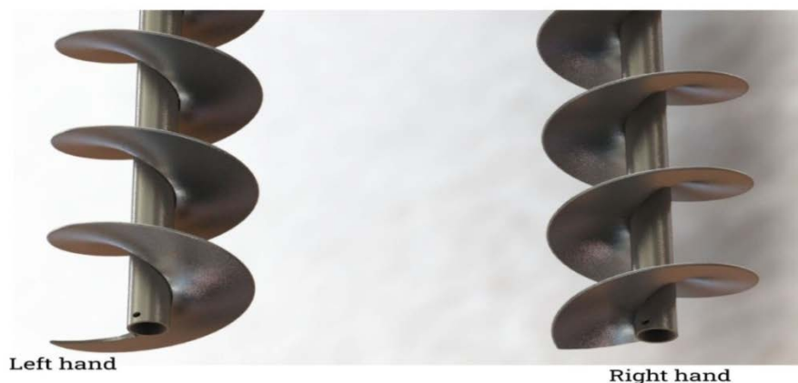
Figure II-2: Sens de rotation de la vis de convoyeur (droite et gauche) [9]
