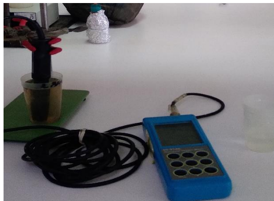
Figure 51 : détermination d'OD par oxymètre ( Photo originale )
