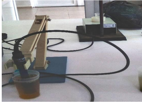
Figure 50 : Mesure de la conductivité électrique ( Photo originale )
