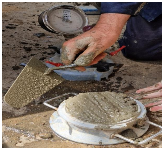
Figure II. 16 : Mise en place du béton frais pour mesurer la teneur en air (BN) .
