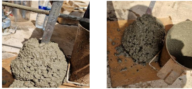
Figure II. 18 : L'essai d'affaissement au cône d'Abrams (béton nodulaire)
