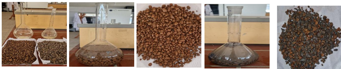
Figure II. 15 : Le mode opératoire de l'essai d'absorption d'eau par la méthode de chiffon
