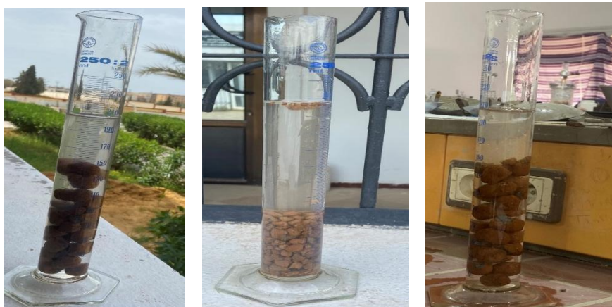
Figure II. 13 : Les masses volumiques absolues à l'aide d'une éprouvette graduée
