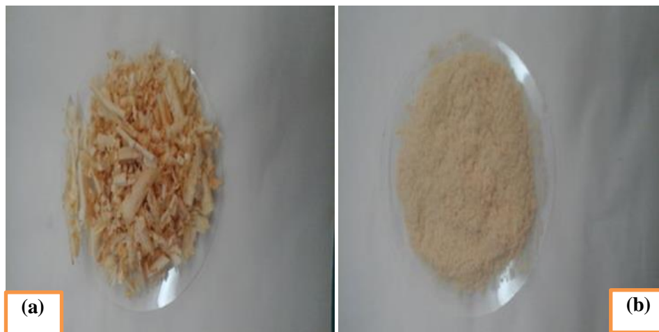
Figure II-1: Morphologie superficielle de la sciure de bois brute (a) et sciure de bois broyé 200 µm (b).
