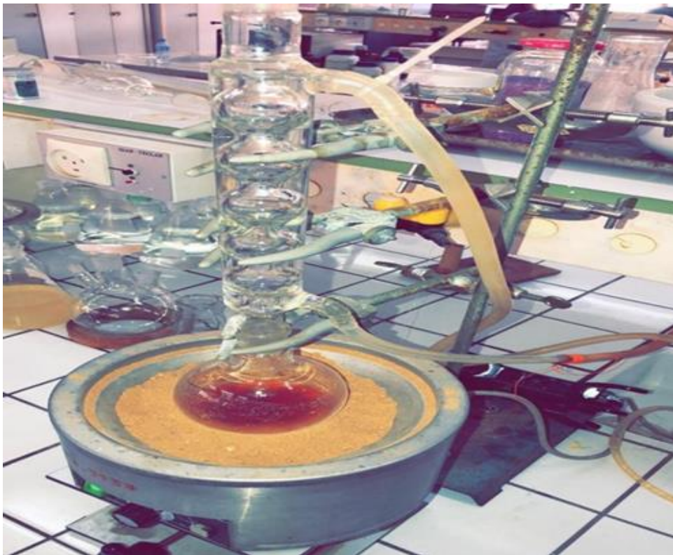
Figure II-2: Traitement organosolv de la lignine par montage reflux.
