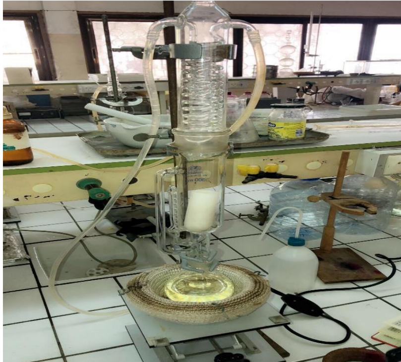
Figure II-5: Extraction par soxhlet.
