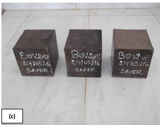
Figure II.14 : Epreuves (10x10x10) cm 3 après décoffrage. a) BOT 00% b) BOV10% c) BOV20% d) BOV30%
