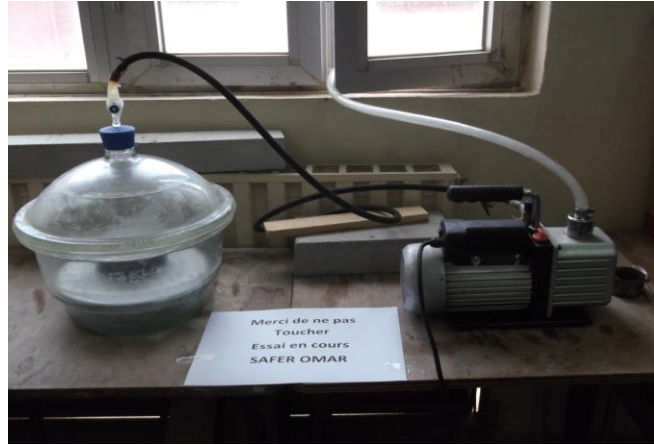
Figure II.23 : Saturation sous vide (Laboratoires EOLE, Université de Tlemcen, Algérie)
