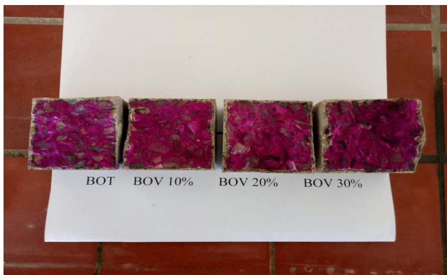
Figure III.25: Carbonatation naturelle à 12 mois
