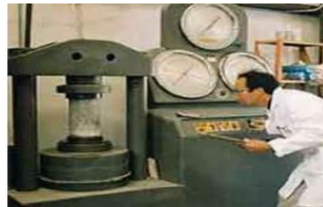
Fig 24 : Ecrasement d'éprouvettes (Diamètre de béton avec une presse hydraulique
