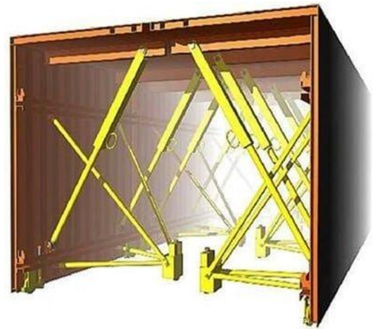
Fig 3 : assemblage deux demi-coquille [theconstructor.org]
