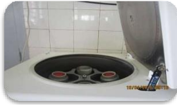
Fig.24 - Extraction de l'extrait de pâte saturée par centrifugation
