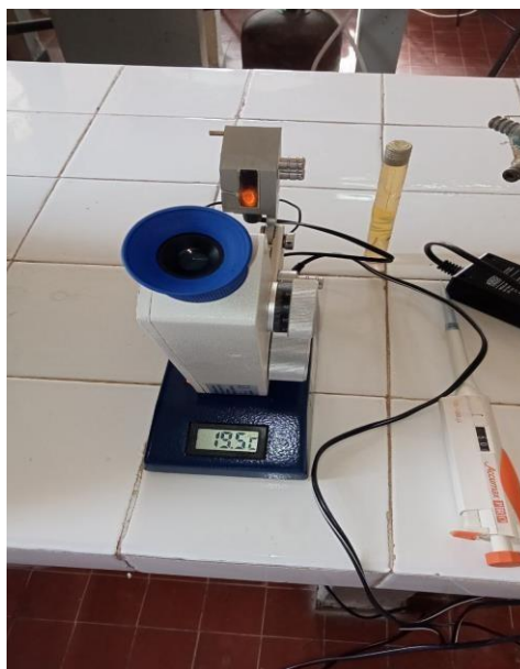
Figure 07 : Refractomètre analyse de brix.
