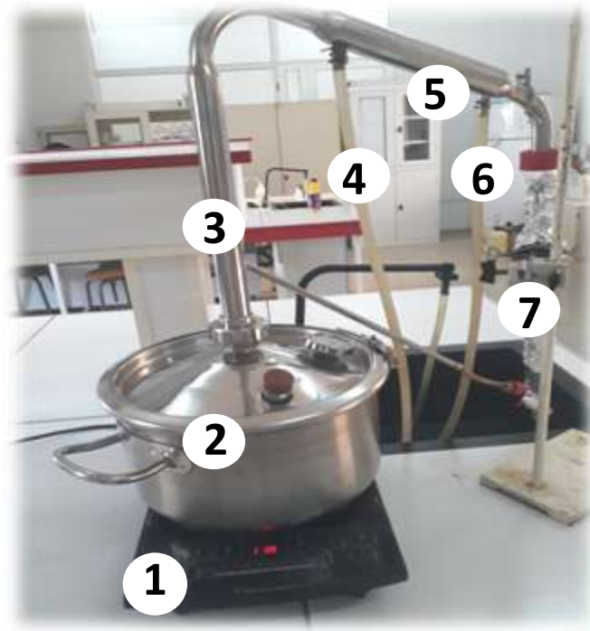
Figure 11 : Montage d'entraînement à la vapeur d'eau. 1 : plaque chauffante, 2 : cocotte-minute 3 : condensateur, 4 : sortie de l'eau, 5 : réfrigérant, 6 : entrée de l'eau et 7 : tube gradué.
