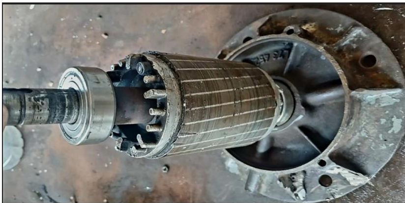
Figure I. 3 Rotor d'une machine asynchrone (RAM Sucre Mostaganem)
