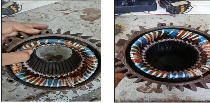
Figure I. 2 Stator d'une machine asynchrone (RAM Sucre Mostaganem)
