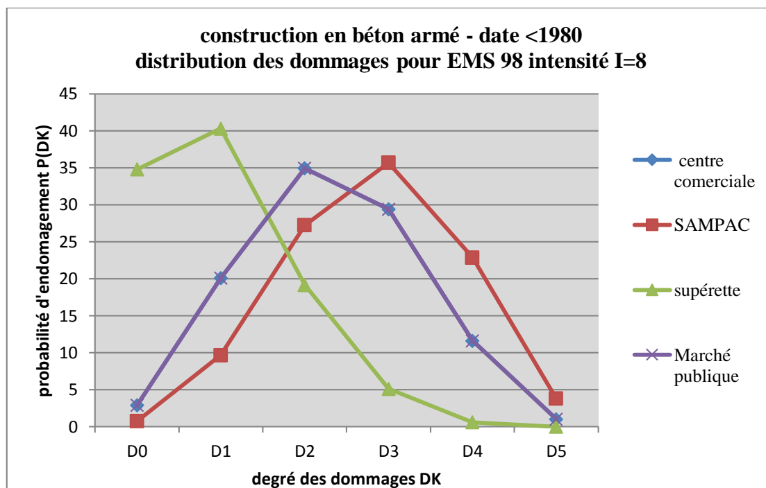
Figure.3.33 distribution des dommages pour les constructions en béton armé (date<1980)
