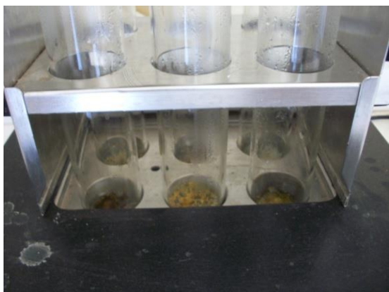
Figure 92 : Digestion à base de \text{NHO}_3 sous 95^\circ\text{C} .
