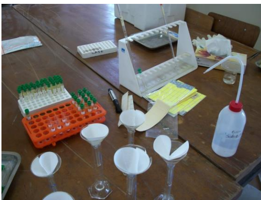
Figure 93 : Filtration et ajustement du minéralisât.
