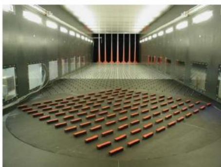
Figure 1: Situation pour MUST expérience du tunnel du vent de l'Université de Hambourg (Bezpalcova and Harms, [9]).
