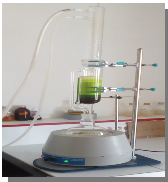
Figure 14 : Résultat de l'extraction par soxhlet (Originale, 2017)
