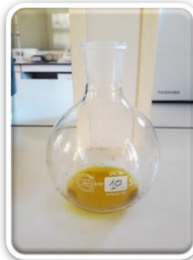
E) Récupération du biodiesel après lavage
