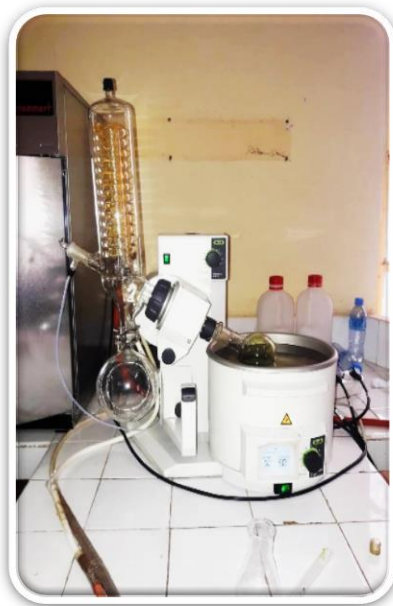
B) Évaporation (Obtenir les huiles et récupération de solvant)
