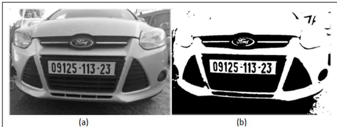
Figure 35 : Binarisation d'image, (a) : Image originale, (b) : Image binaire
