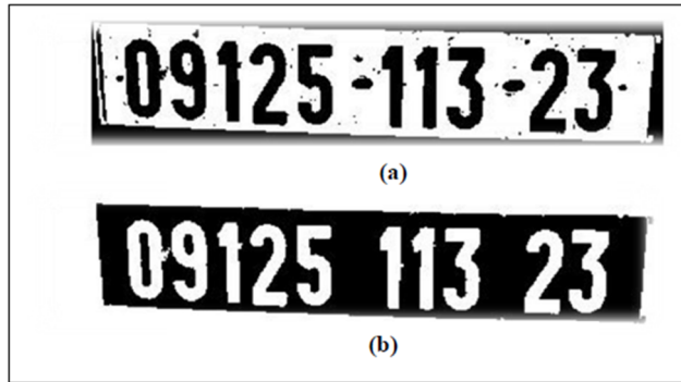
Figure 39 : Suppression des objets indésirables, (a) : Avant la suppression, (b) : Après la suppression
