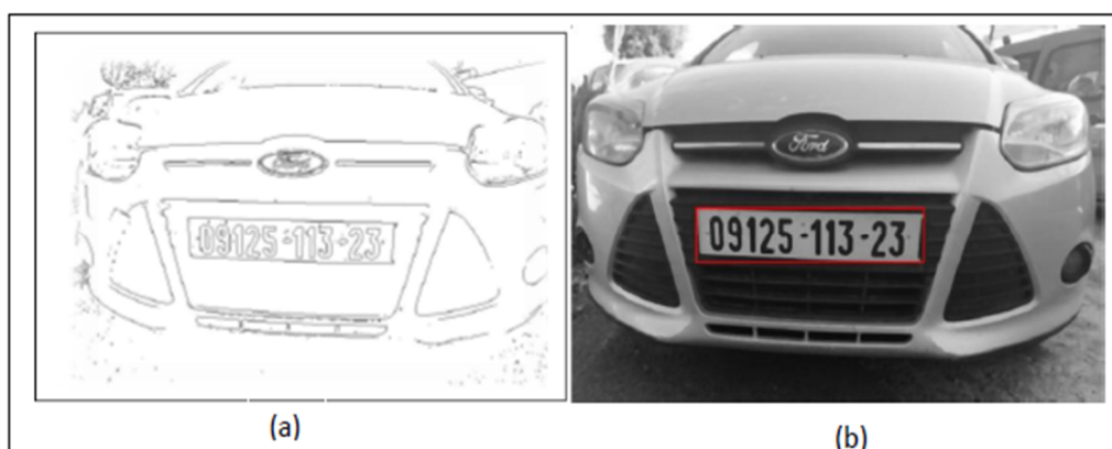
Figure 38 : Localisation de la plaque, (a) : Détection de contour, (b) : Localisation la région de la plaque
