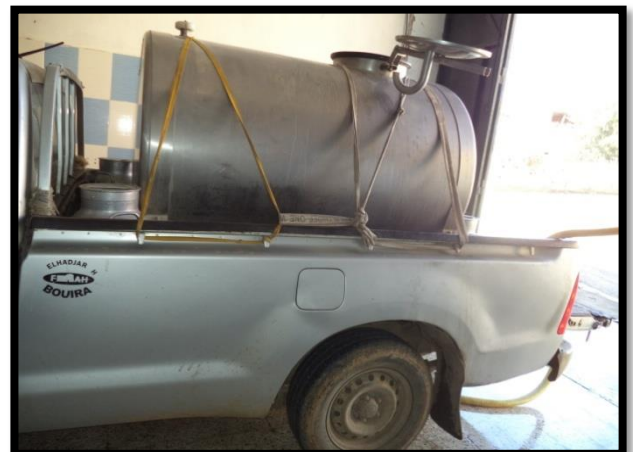
Photo 6: cuve à lait Milkplan Alpha 200 transport.
