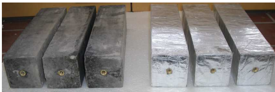
Fig. III.35: Eprouvettes prismatiques de dimensions ( 7 \times 7 \times 28 \text{ cm}^3 ) équipées de plots
