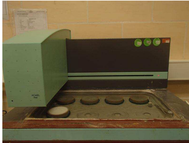
Fig. III.13: Appareil de Vicat Automatique pour la détermination des temps de prise.
