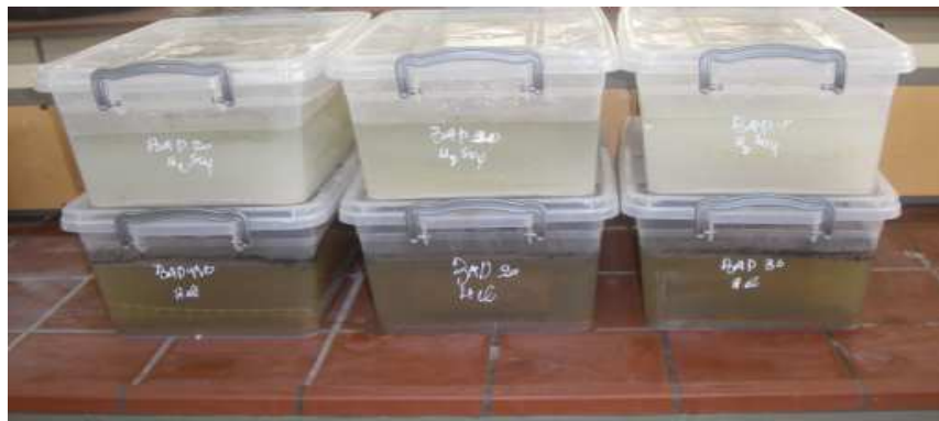
Fig. III.31: Eprouvettes de bétons immergés dans les attaques acides
