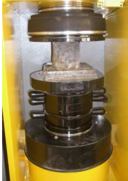
Fig. III.27 : Presse des éprouvettes du béton.
