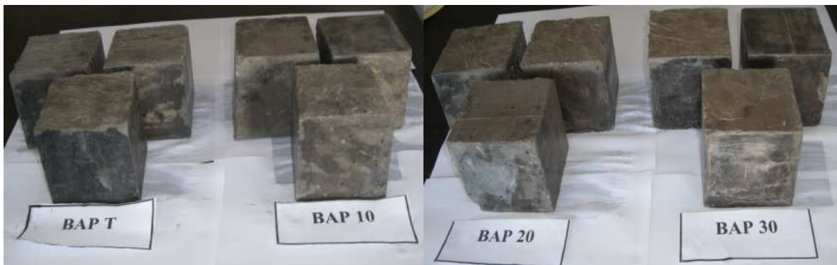
Fig. III.26 : Confection des éprouvettes cubique en béton autoplaçant
