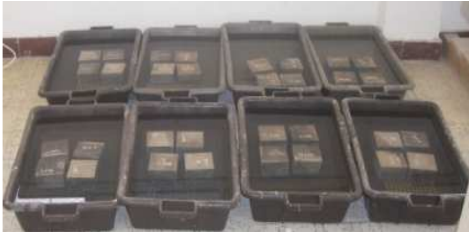
Fig. III.34: Eprouvettes de bétons immergés dans les solutions sulfatiques
