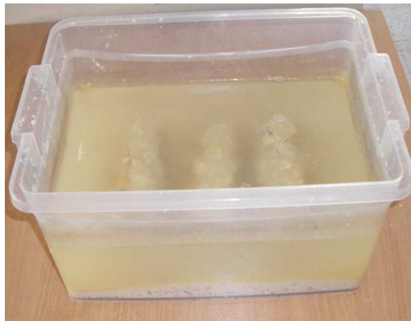
Fig. IV.19: Etat des éprouvettes de bétons immergés dans les attaques acides H_2SO_4
