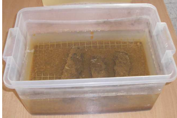
Fig. IV.22: Etat des éprouvettes de bétons immergés dans l'attaque acide HCL
