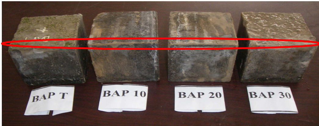
Fig. IV.26: Etats des surfaces des éprouvettes des BAP immergées dans \text{Na}_2\text{SO}_4 après 360 Jours
