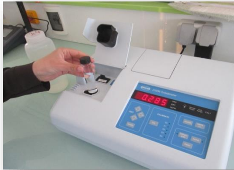
Figure 06 : mesure de la turbidité par turbidimètre.
