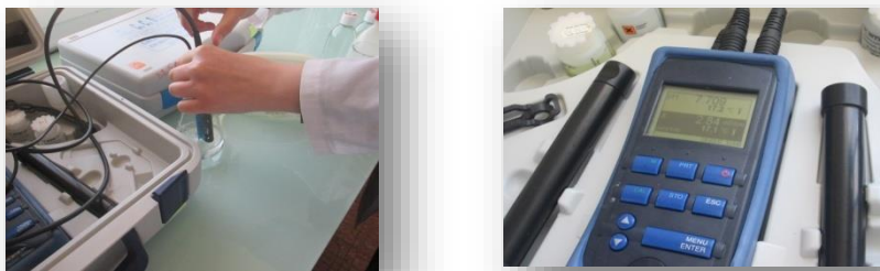
Figure 05 : Mesure d'une pH à l'aide d'un multi paramètres
