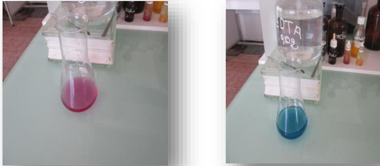
Figure 07 : le virage de couleur après le titrage avec l'EDTA.
