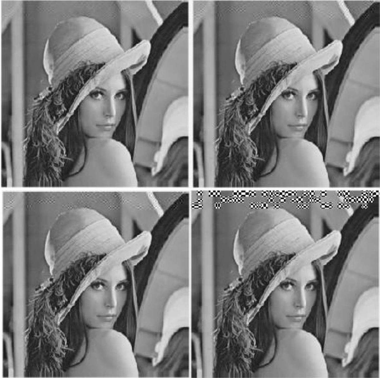
Figure 2.59 : Modification adaptative des coefficients DCT du bloc (3:5,3:5) avec redondance : LSB, Avant LSB, LSB & Avant LSB, MSB (Image Lena pour Q50)
