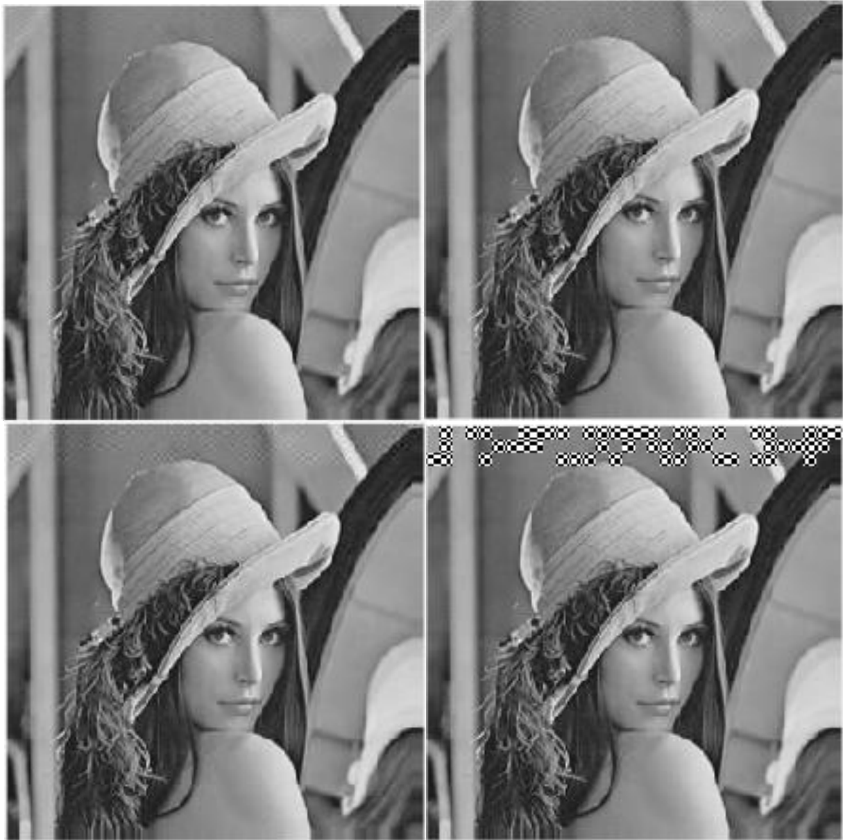
Figure 2.36 : Modification adaptative du coefficient DCT (4,4) sans redondance : LSB, Avant LSB, LSB & Avant LSB, MSB (Image Lena pour Q60)
