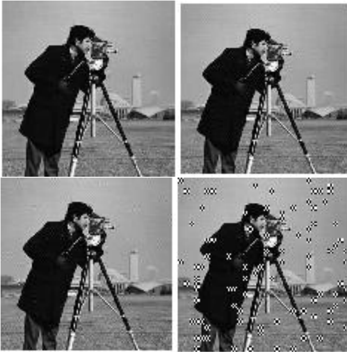
Figure 2.53 : Modification aléatoire du coefficient DCT au hasard du bloc (3:5,3:5) avec redondance : LSB, Avant LSB, LSB & Avant LSB, MSB (Image Cameraman pour Q50)
