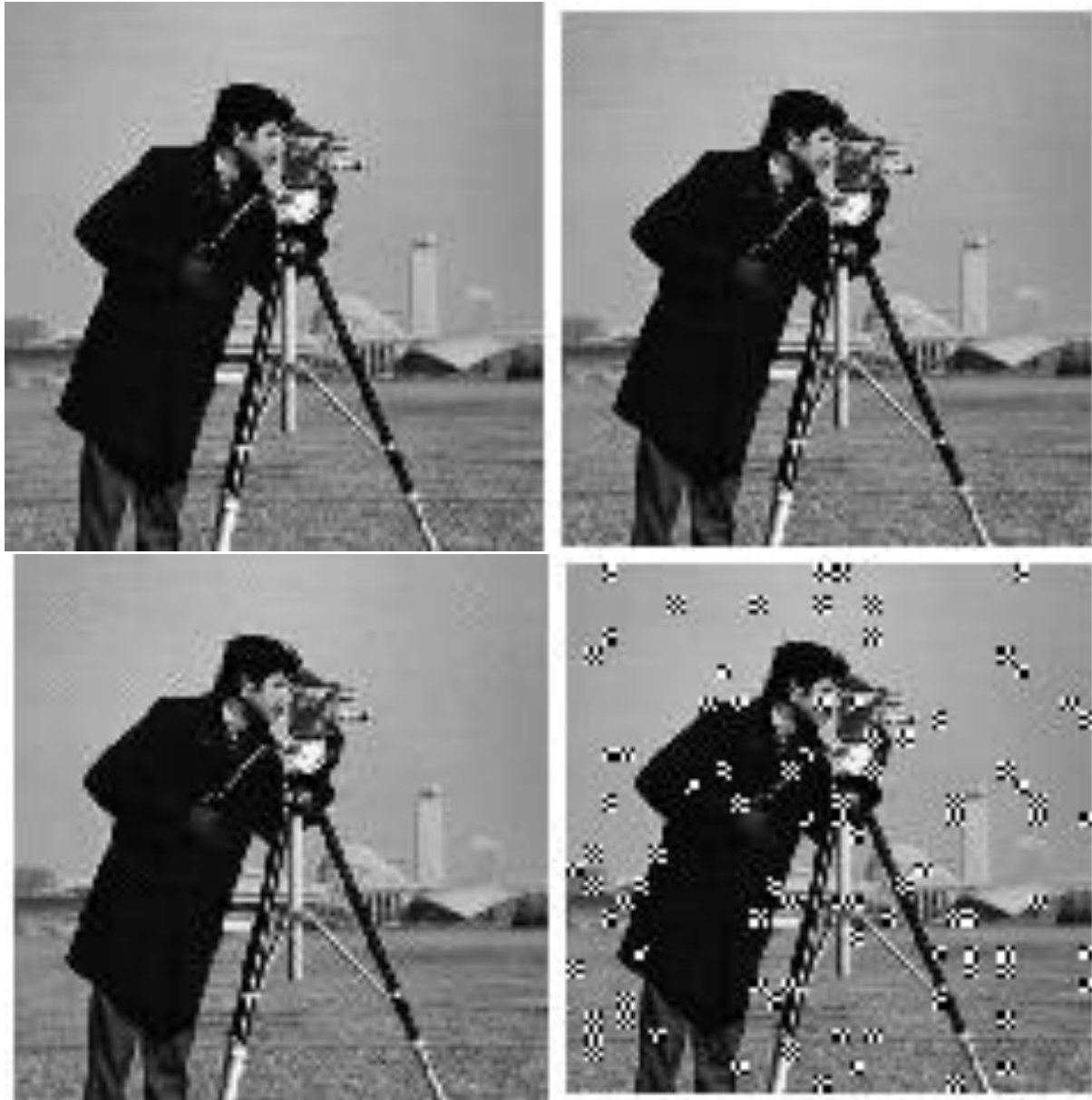
Figure 2.52 : Modification aléatoire du coefficient DCT (4,4) avec redondance : LSB, Avant LSB, LSB & Avant LSB, MSB (Image Cameraman pour Q50)
