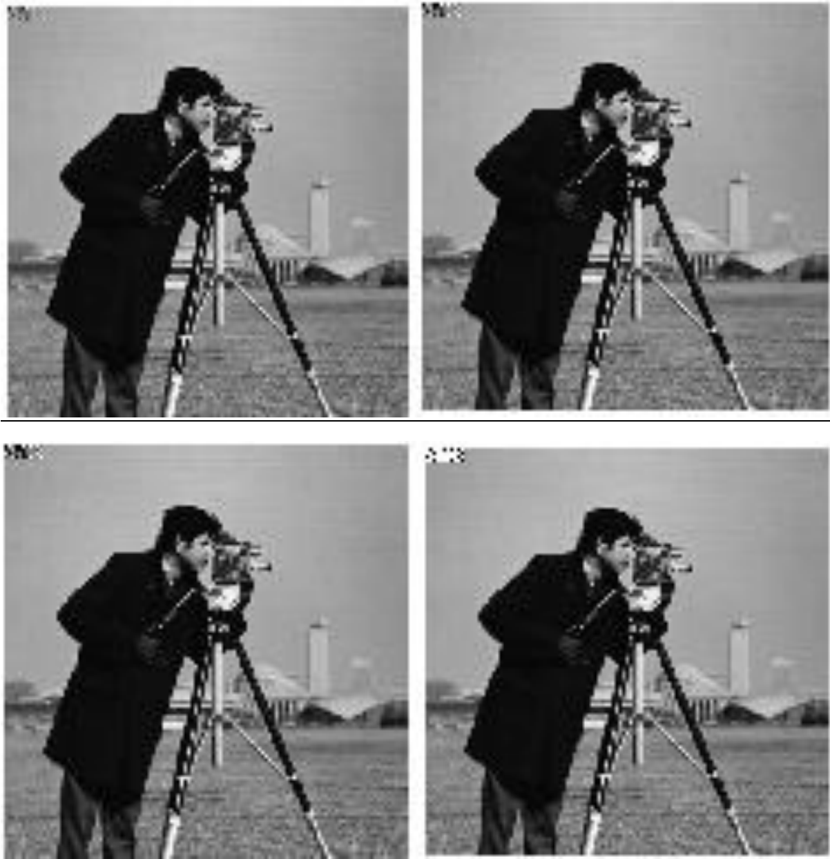
Figure 2.62 : Modification adaptative des coefficients DCT sauf DC avec redondance : LSB, Avant LSB, LSB & Avant LSB, MSB (Image Cameraman pour Q50)
