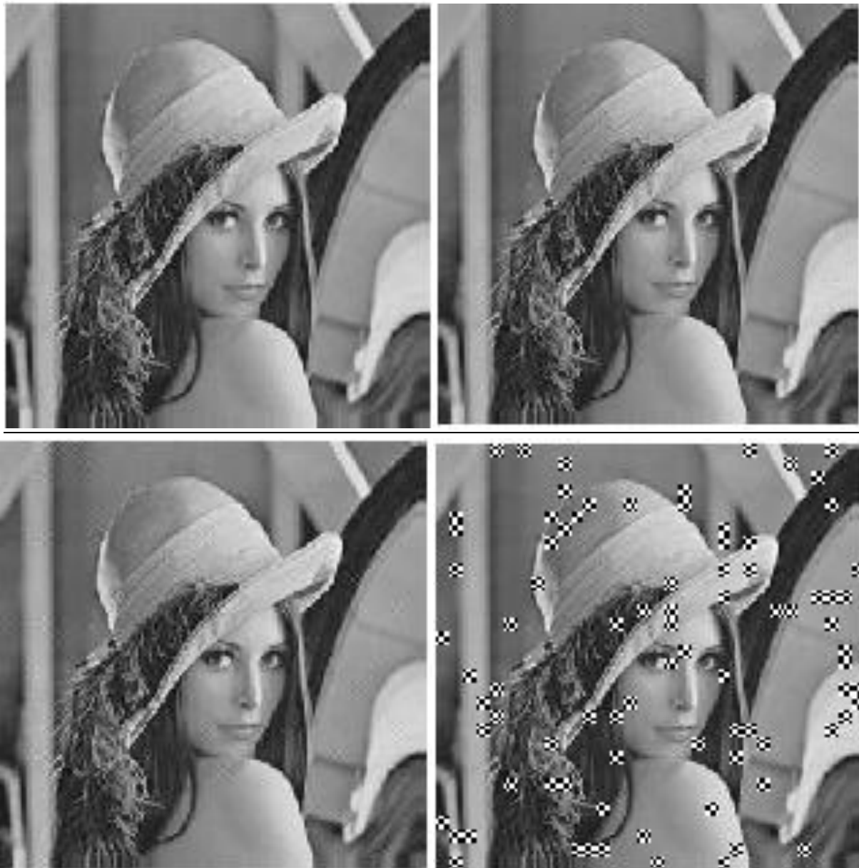
Figure 2.48 : Modification aléatoire du coefficient DCT (4,4) avec redondance : LSB, Avant LSB, LSB & Avant LSB, MSB (Image Lena pour Q50)
