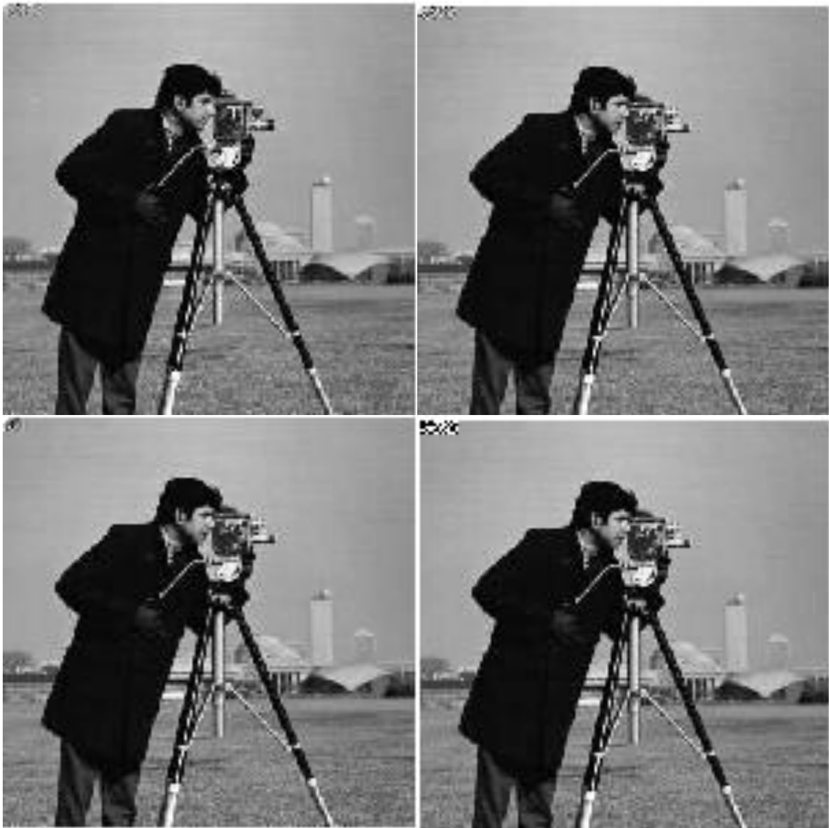
Figure 2.50 : Modification aléatoire des coefficients DCT sauf DC avec redondance : LSB , Avant LSB , LSB & Avant LSB , MSB (Image Cameraman pour Q50 )
