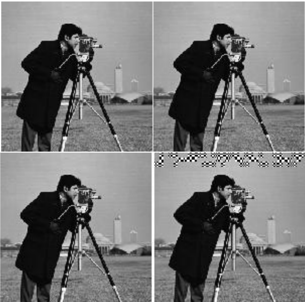
Figure 2.40 : Modification adaptative du coefficient DCT (4,4) sans redondance : LSB, Avant LSB, LSB & Avant LSB ave Q50 et MSB avec Q90 (Image Cameraman)
