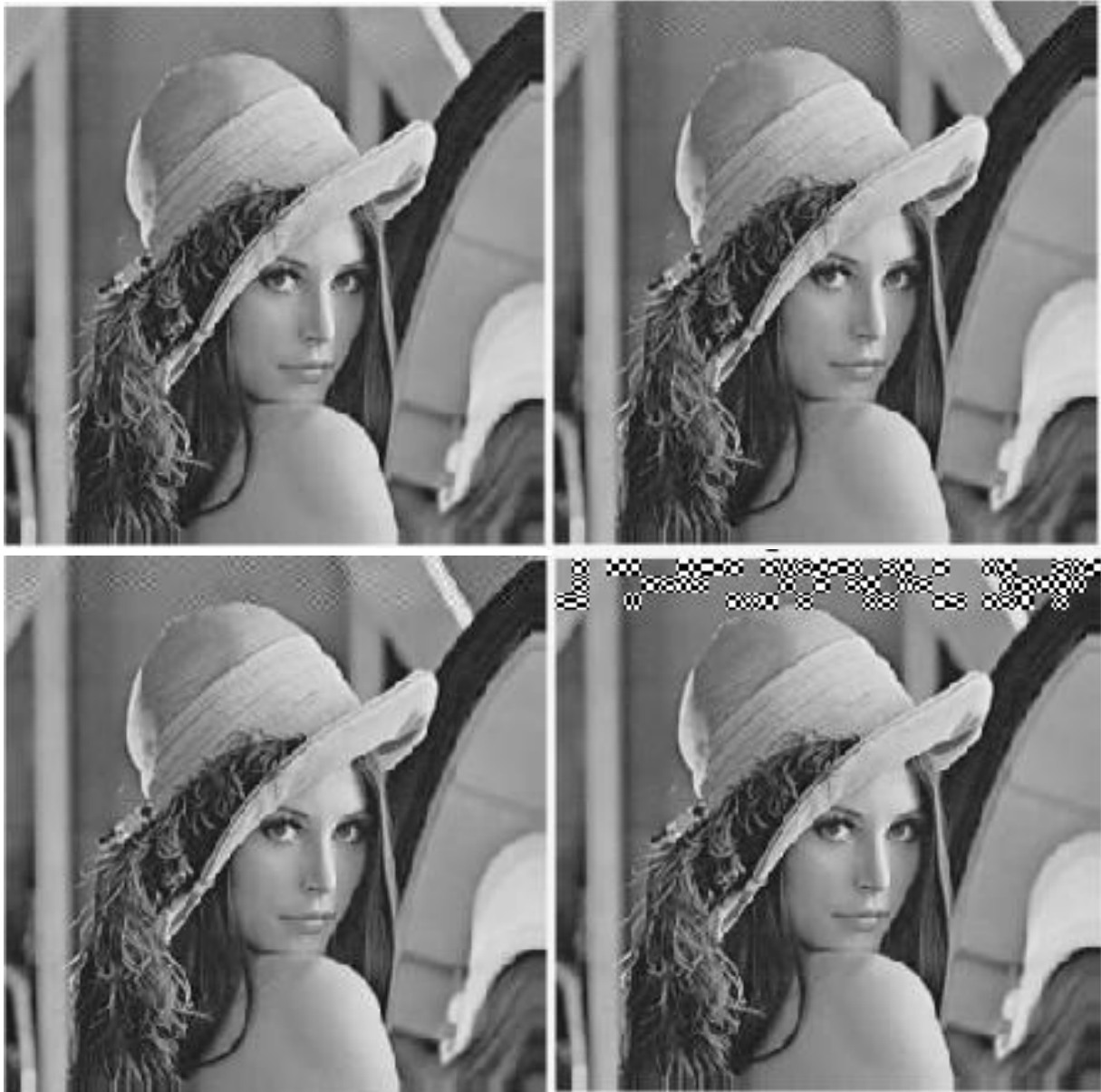
Figure 2.35 : Modification adaptative des coefficients DCT du bloc (3:5,3:5) sans redondance : LSB, Avant LSB, LSB & Avant LSB, MSB (Image Lena pour Q60)
