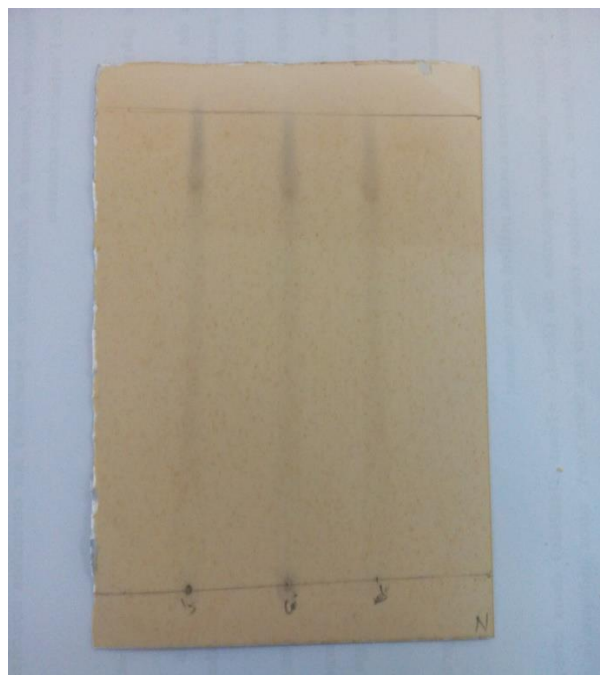
Fig N°17 : étude de séparation des principes actifs des flavonoïdes de la menthe.
