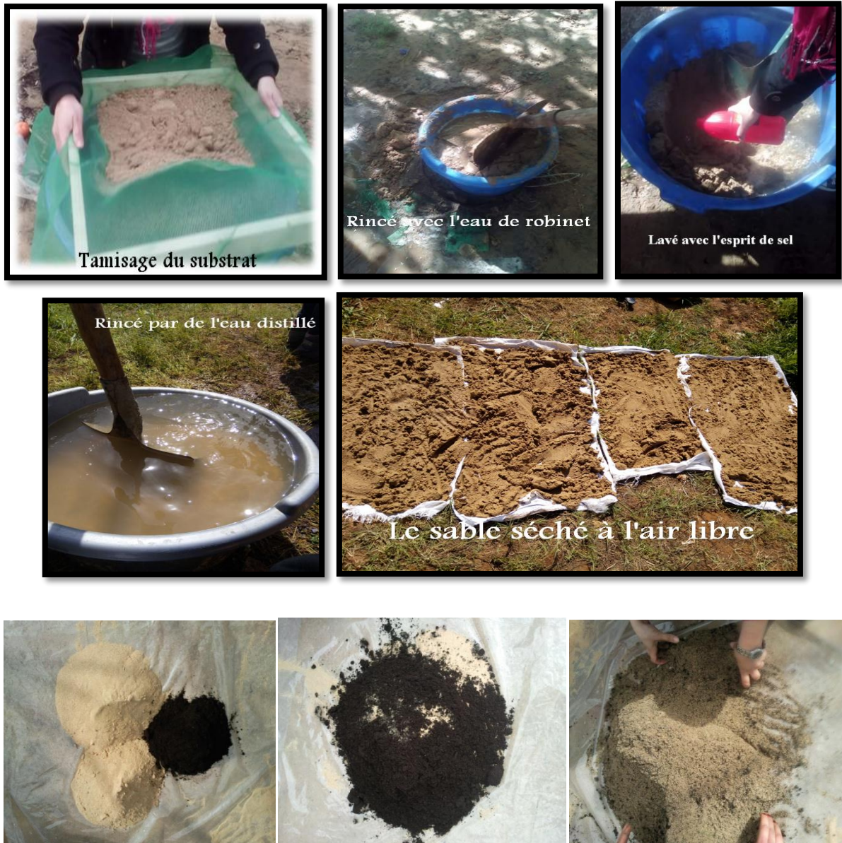
Figure 7 : Les étapes de préparation de sable et d'un mélange de sable et de terreau (Originale, 2017)
