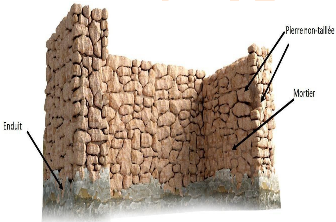
Figure 08: Typologie constructive d'un mur extérieur en maçonnerie.
