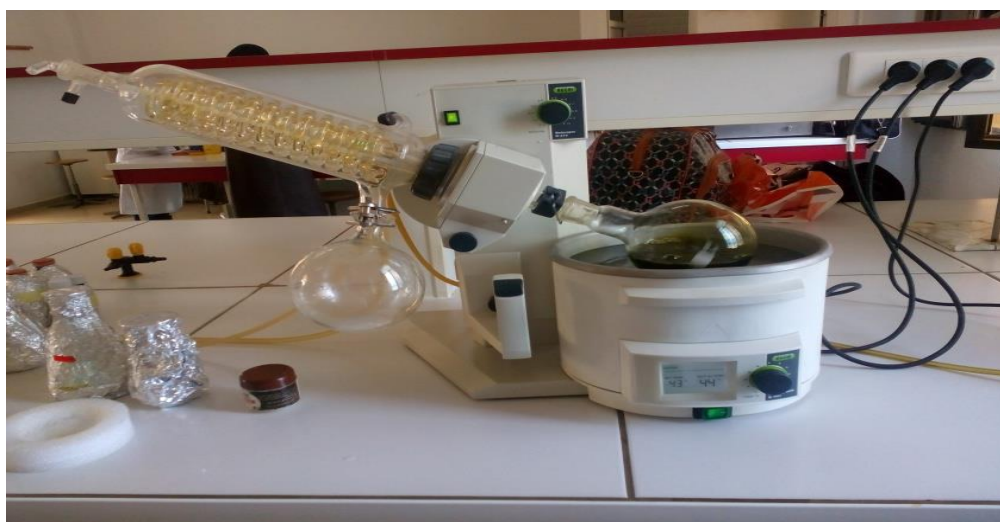
Figure 10 : Etape d'évaporation sous vide de récupération des extraits d' Urtica dioica
