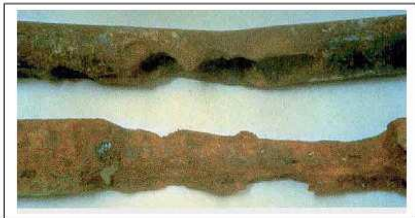
Figure 5: Piqure profonde causée par une attaque de chlorure.
