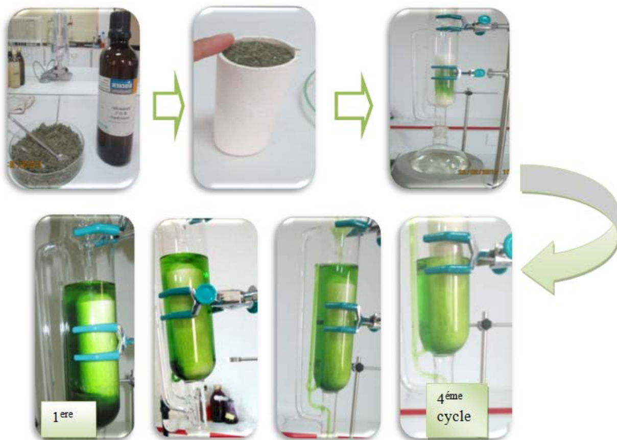
Planche :2 Les étapes de l'extraction par le dispositif Soxhlet(original2017)
