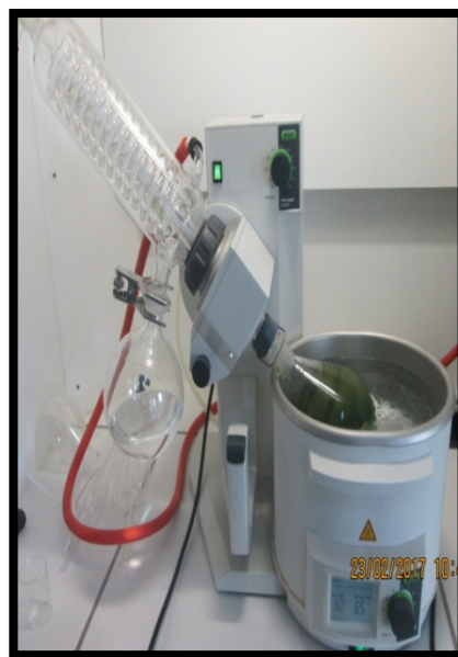
Fig.9 : Montage du dispositif soxhlet Fig10 : Montage du rotavapeur(original2017)
