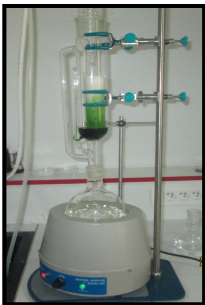
Fig.9 : Montage du dispositif soxhlet Fig10 : Montage du rotavapeur(original2017)
