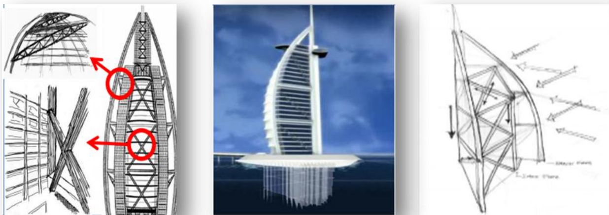
Figure 49: Système constructif du l'hôtel Burdj El Arab.
