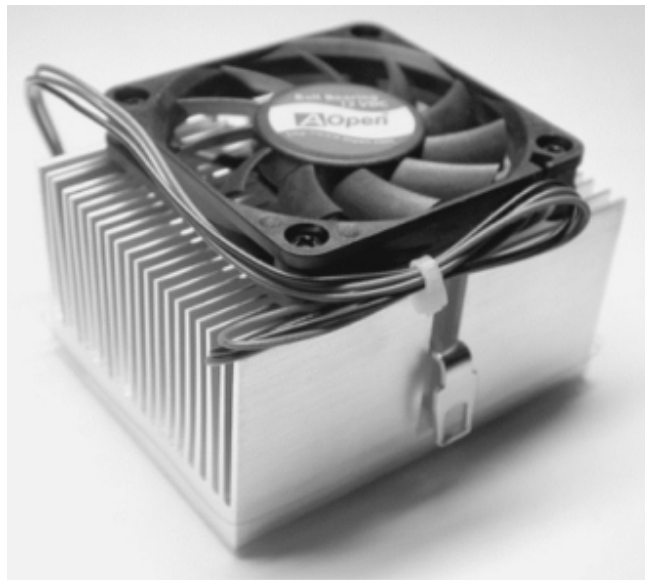
Figure I. 12. Configuration d'un ventirad [27].
