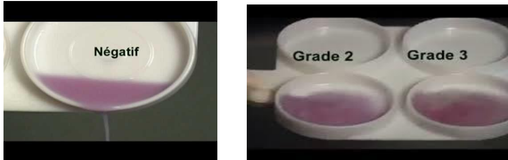
Figure 09 : Interprétation de test CMT ( Remy, 2010 ).
