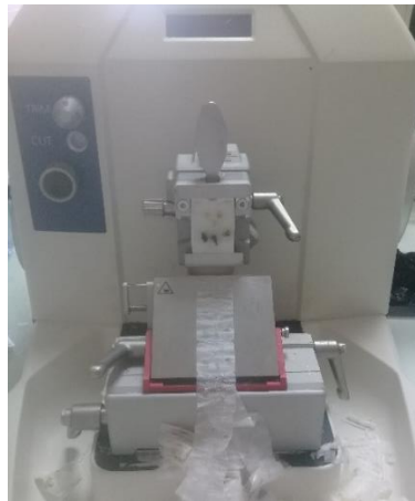
Figure 19 : Coupe et formation de rubans à l'aide d'un microtome.
