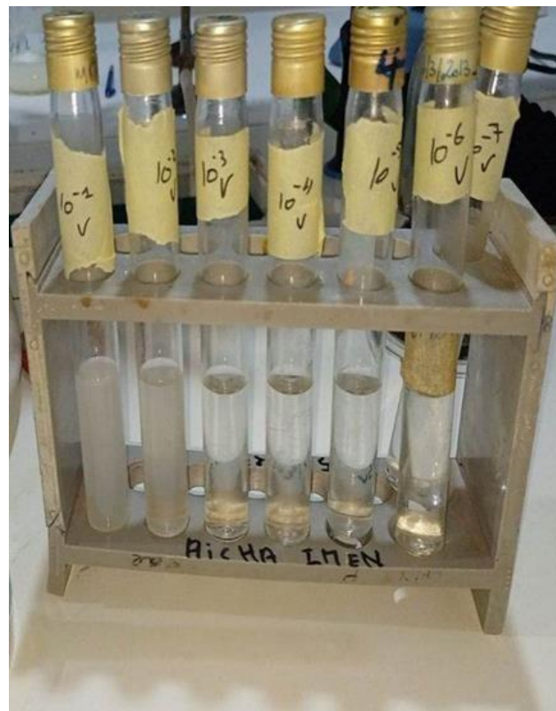
Figure 14: Préparation des dilutions de beurre du 10^{-1} à 10^{-7}
