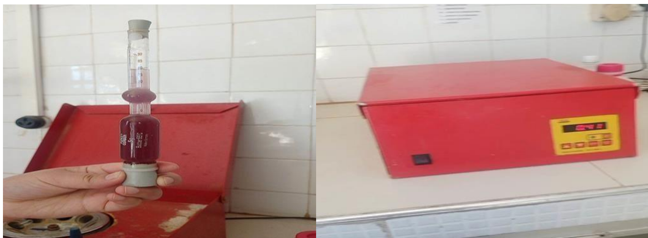
Figure 12: Détermination de la matière grasse du beurre fermier brebis et vache
