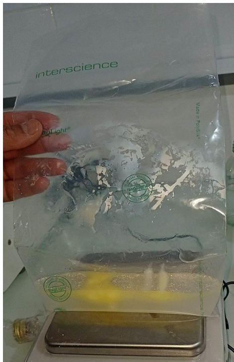
Figure13: Préparation de la solution mère avec le stomacher
