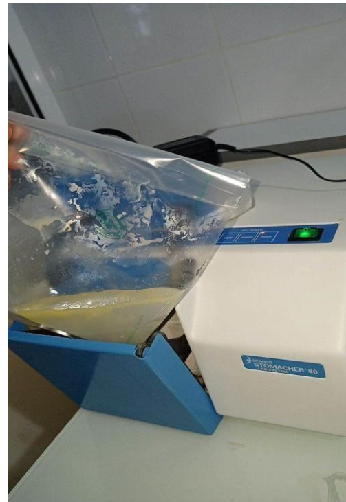
Figure13: Préparation de la solution mère avec le stomacher
