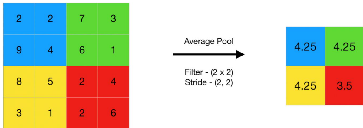
Figure 3 : Exemple de processus du Average Pooling [7].
