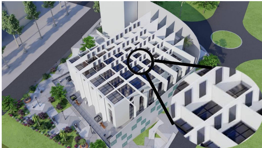
Figure 77 l'emplacement de panneaux solaire
