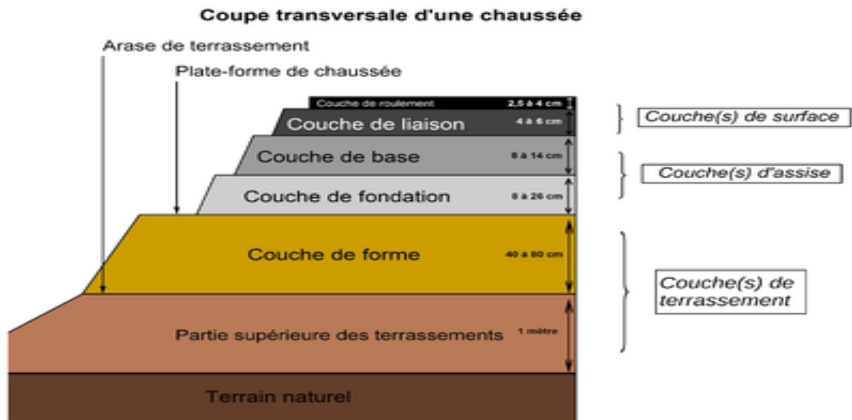
FIGURE.IX. 1:coupe transversale d'une structure de chaussée
