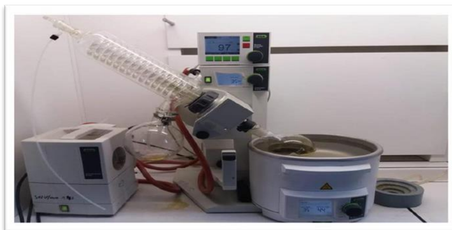
Figure 15 : Montage de l'évaporateur rotatif de laboratoire
