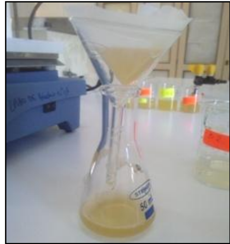
Fig. 17 : Etape de filtration pour un seul échantillon.
